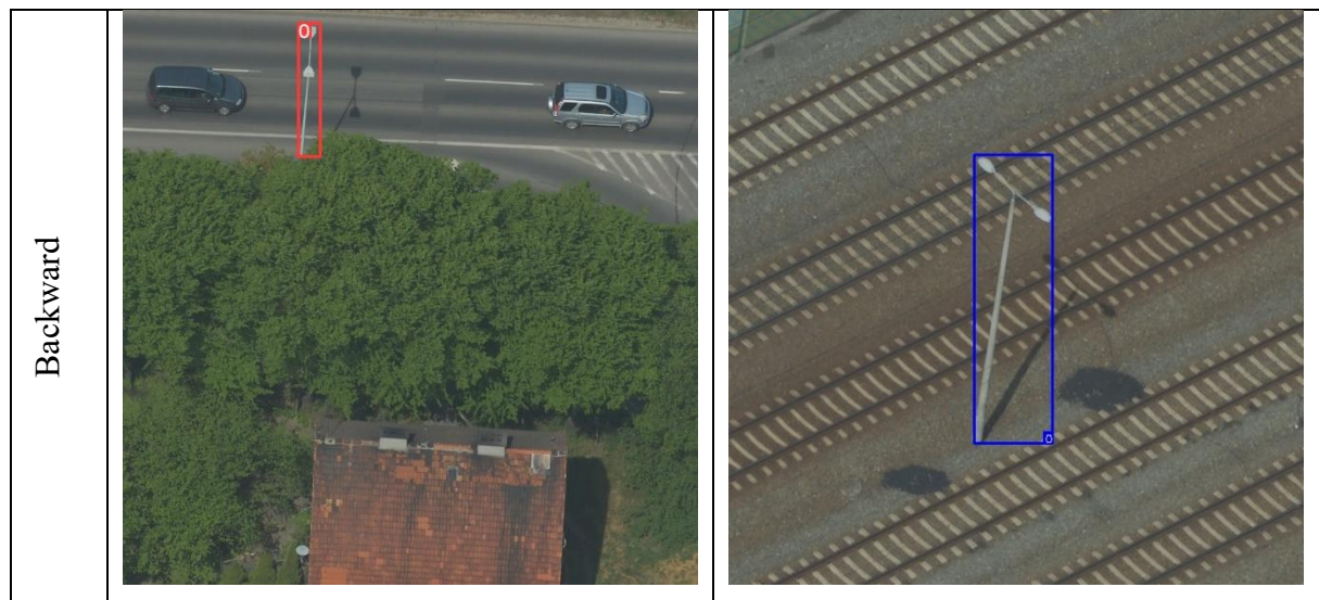
Rysunek 18 Przykładowe wyniki detekcji latarni wytrenowanym modelem YOLOv8 dla czterech kierunków ukośnych i kierunku nadir.
