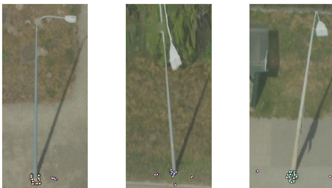
Rysunek 58 Przykładowe wyniki klasteryzacji DBSCAN i odrzucenie wartości odstających.
