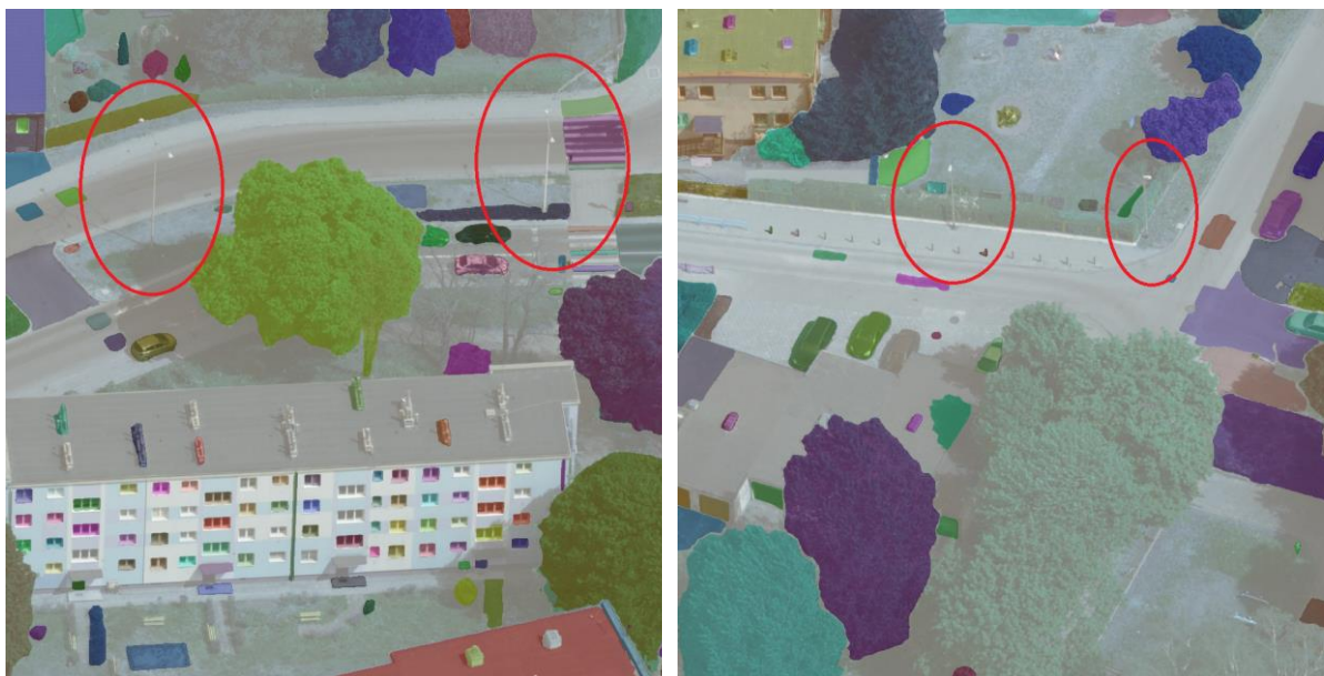
Rysunek 19 Wyniki segmentacji całych kafelków obrazu za pomocą modelu SAM, gdzie zaznaczono brak wyodrębnionych latarni.
