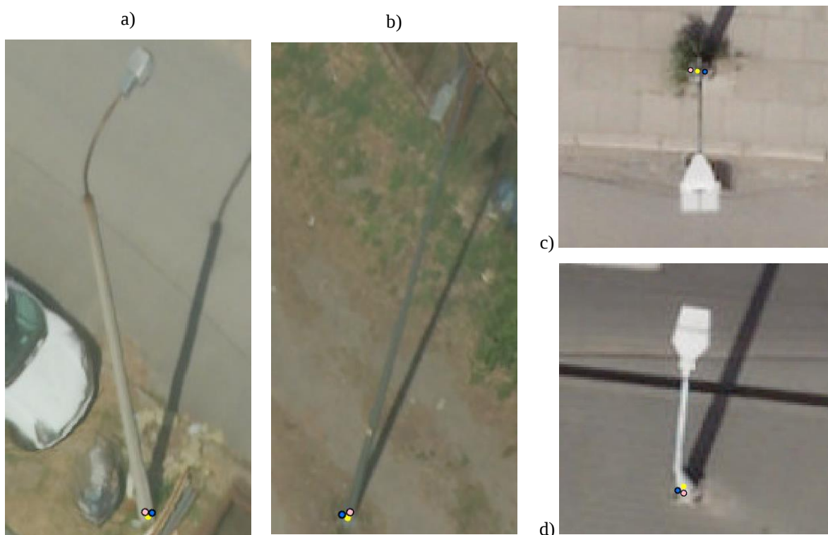
Rysunek 60 Wyniki wyznaczenia lokalizacji punktów dla latarni wyświetlone na podkładzie ortofotomapa (a i b) oraz na podkładzie true-ortofotomapa (c i d). Oznaczenia punktów: niebieski – wynik wcięcia w przód; różowy – wynik rzutowania; żółty – referencja.
