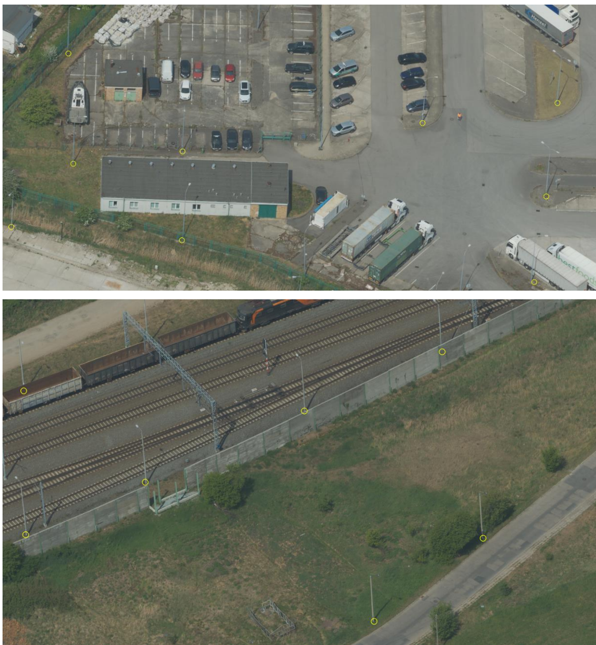
Rysunek 54 Wyniki działania algorytmu definiowania punktów przyziemia na podstawie wykrytych za pomocą modelu ramek ograniczających latarnie.
