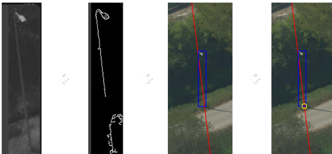
Rysunek 49 Przykład działania algorytmu wpasowania prostej i wyszukania punktu przyziemia latarni.
