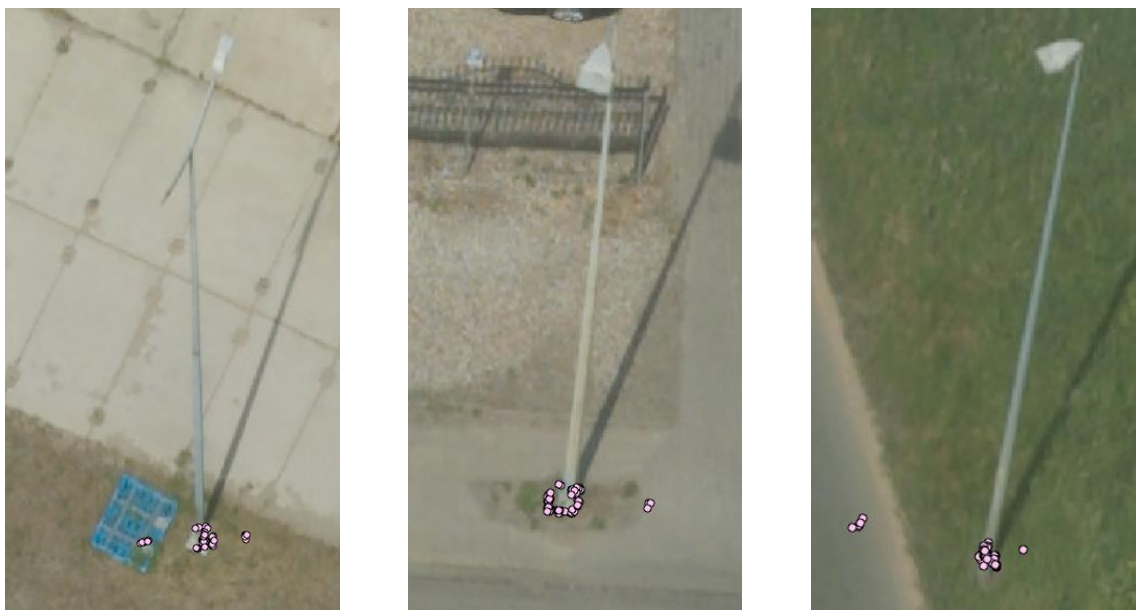
Rysunek 57 Wyniki rzutowania punktów z układu pikselowego zdjęcia do terenowego układu współrzędnych dla trzech przykładowych latarni. Jako podkład posłużyła ortofotomapa.
