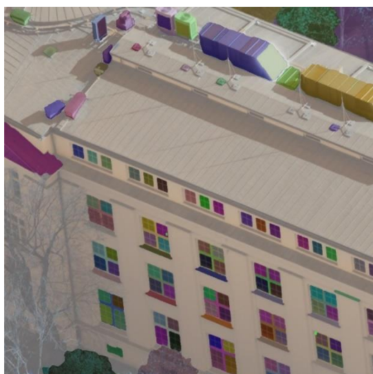
Rysunek 31 Wynik segmentacji obrazu z wykorzystaniem modelu SAM, gdzie każdy kolor oznacza oddzielną maskę.
